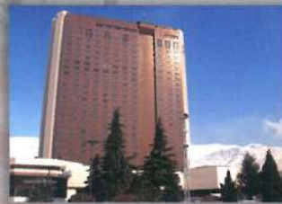
هتل بزرگ آزادی تهران - بهسازی لوزه ای ساختمان ۲۸ طبقه بتنی تقویت ستونها با FRP و استفاده از میراگرهای هیدرولیک با همکاری شرکتهای EMPA و SMTTeam (سوئیس)
